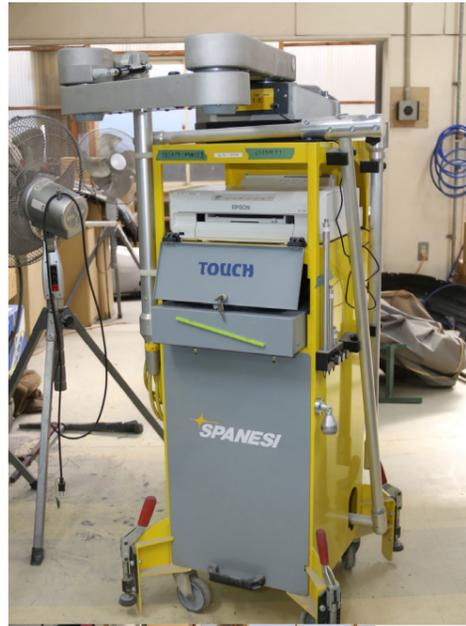
ボディの歪みを計測する「三次元計測機」
