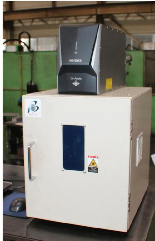
3軸同時レーザー制御システム搭載のレーザーマーカ
