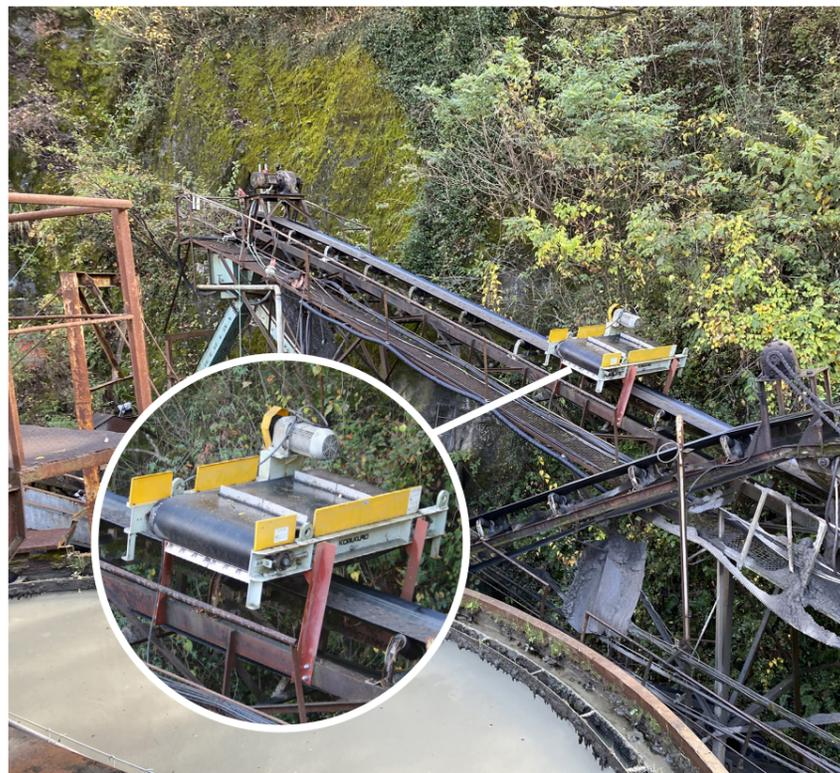
砕砂プラントに設置された永久磁石連続排出口式の鉄片除去機
