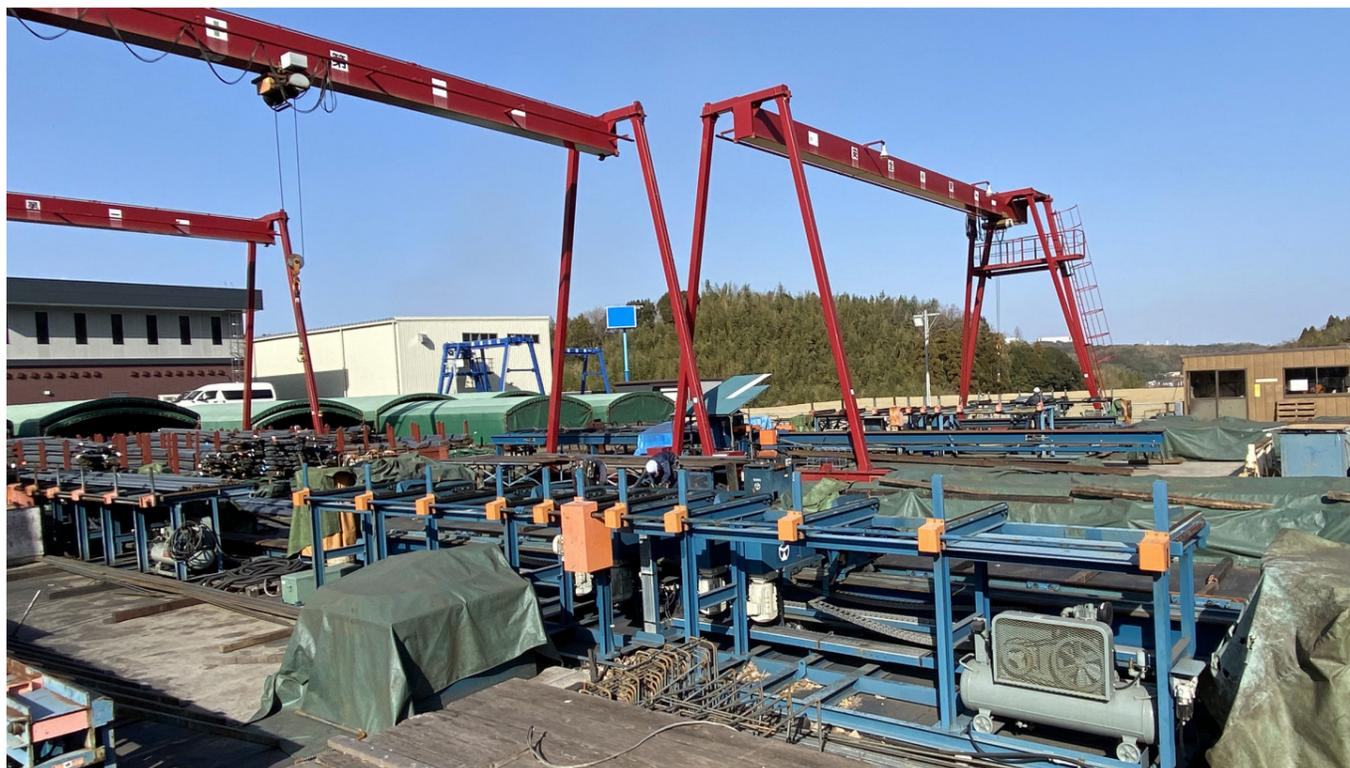
新しい鉄筋自動曲装置の導入により高強度かつ鉄筋径の大きい鉄筋にも対応が可能となり、一度に曲げる本数も増加したので効率性も高まった
