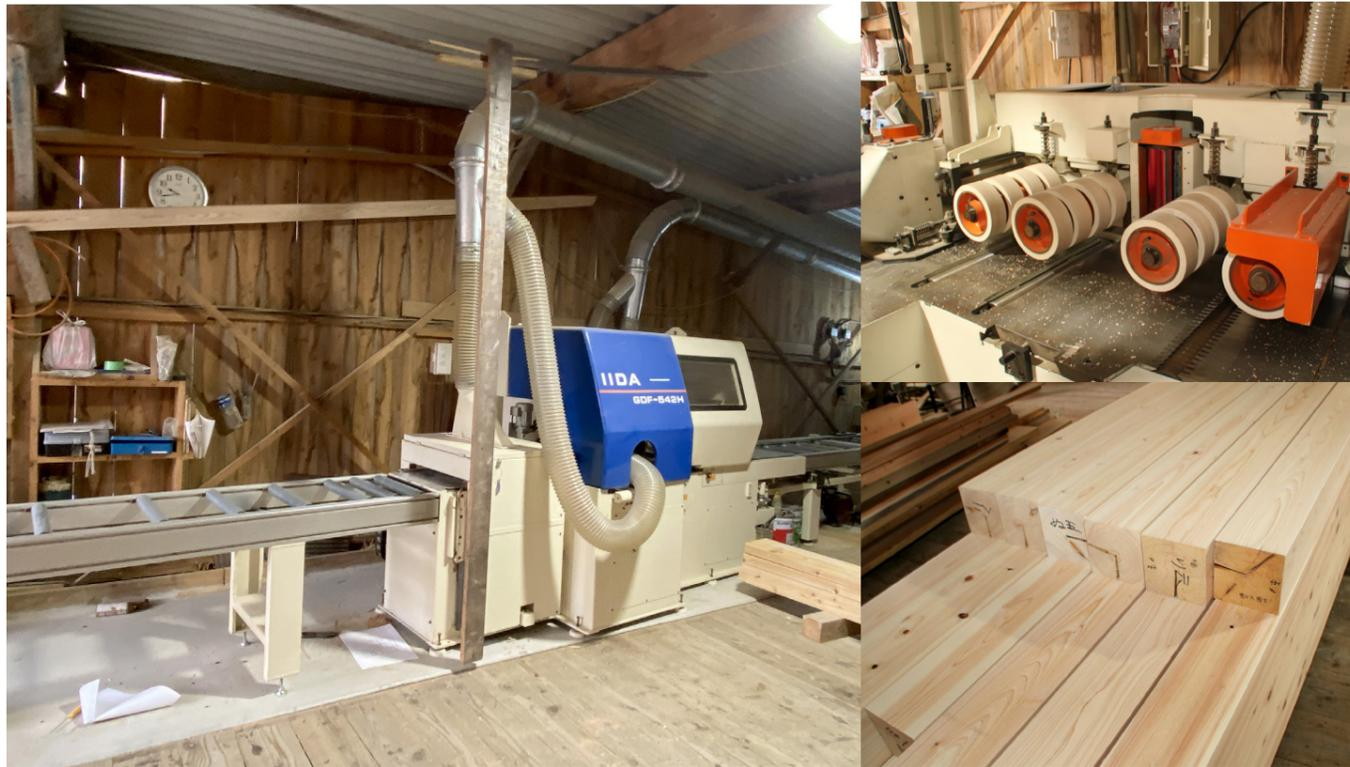
上下左右の四方向すべての側面を1回の加工作業で切削できる四面自動<sup>かな</sup>鉋盤のおかげで劇的に作業効率は向上した
