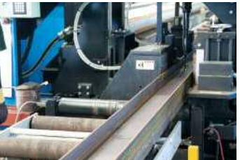
コンピュータ制御による切断加工
