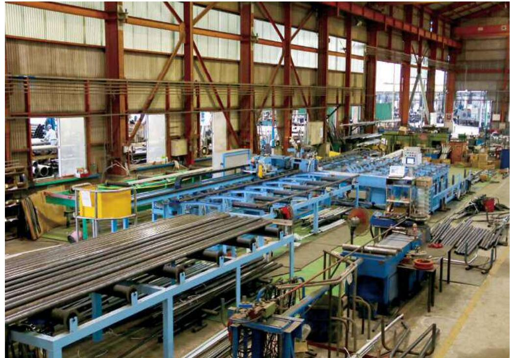
パイプ自動切断機を導入したライン。大成工業の独自仕様に設計されている
