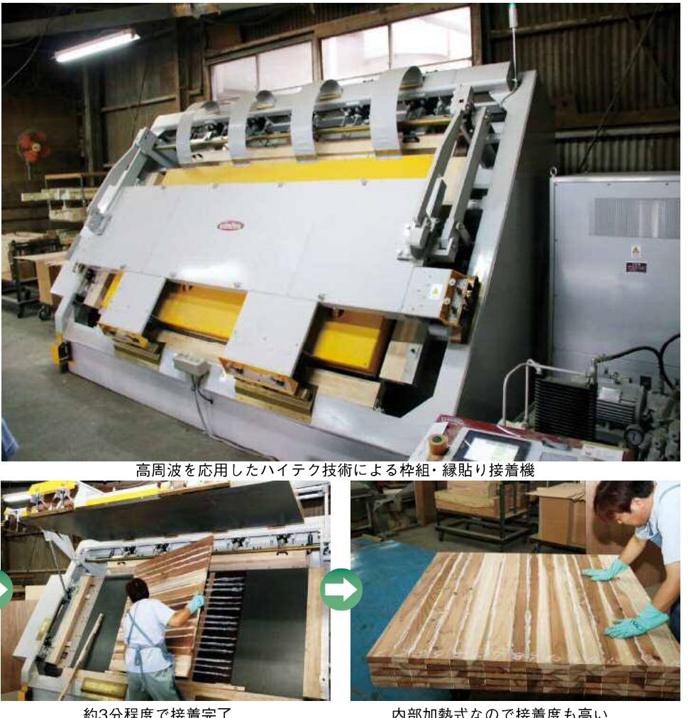
傾斜型プレスなので作業員も操作しやすい
