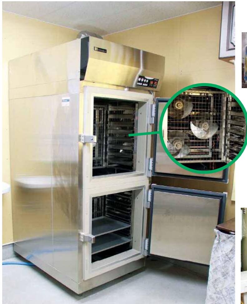
3Dフリーザー方式の急速冷凍機。ファンモーターが包み込むように冷やす
