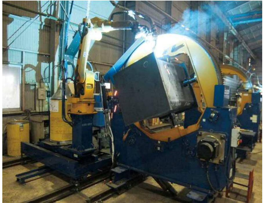
鉄骨柱大組立溶接口ボットシステム
