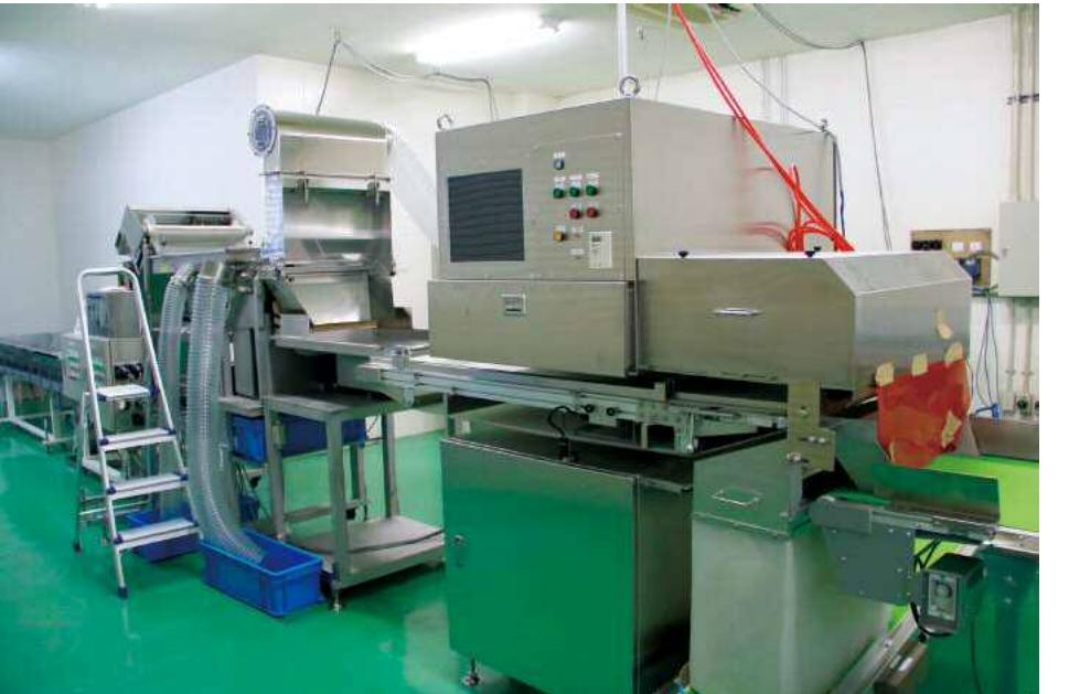
乾燥食品用除塵機と画像処理検査選別装置を導入した生産ライン
