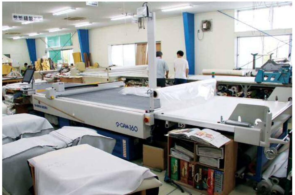
3D-CADと連動した最新型のプロジェクター付き自動裁断機
